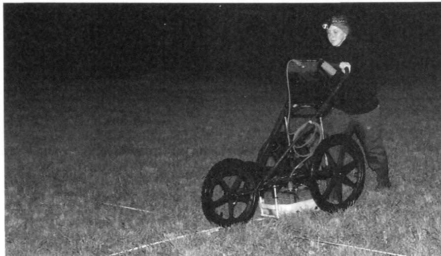
Abb. 4: Messung mit „Cart“ und 400-MHz-Antenne
