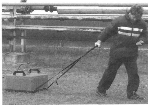
Abb. 1: 200-MHz-Antenne
