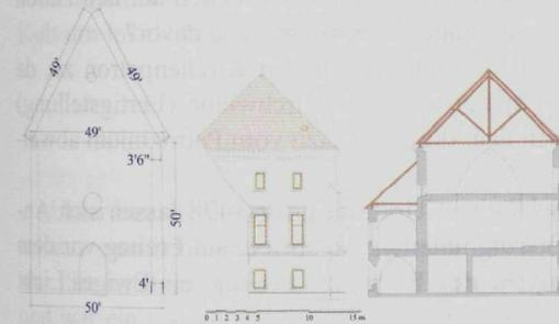
Abb. 39: Rekonstruierte Westfassade mit Maßzahlen, Westfassade und Schnitt 2002
